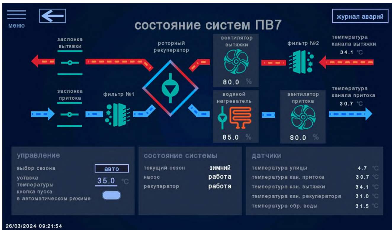
Рисунок 6 – Меню «состояние системы» для системы ПВ7
