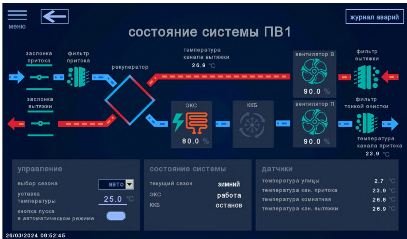
Рисунок 5 – Меню «состояние системы» для системы ПВ1
