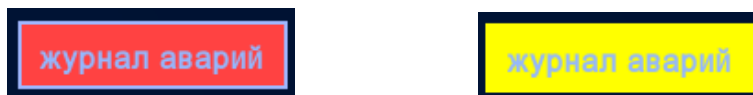
Рисунок 4 – Кнопка «журнал аварий» при критической аварии (красный цвет) и при аварии, не влияющей на работу системы (жёлтый цвет)
